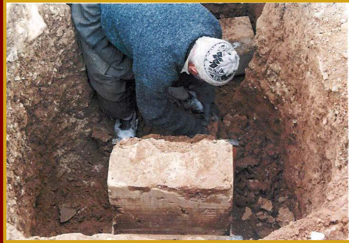
حفر چاله و تهیه بلوک برای انجام آزمایش
