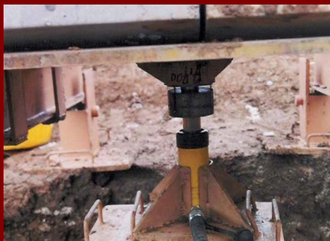
چگونگی تنظیمات دستگاه برای ایجاد نیروی قائم
