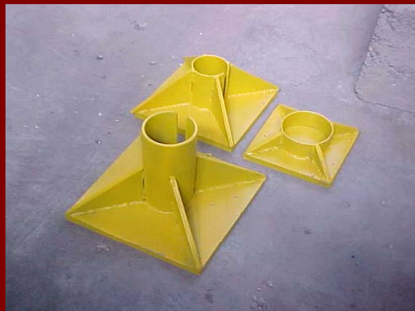
صفحات پایه: جهت قرار گیری جک های هیدرولیکی
