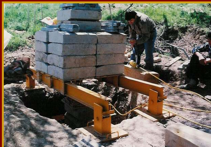
بارگذاری قائم بوسیله سیستم سکو، شاسی و پایه های غلتکی
