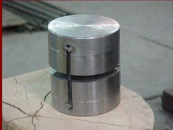
سیستم طراحی شده جهت محوری کردن نیروی برشی
