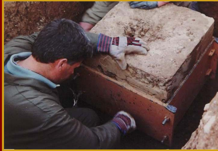
جایگذاری قالب برش بر روی نمونه
